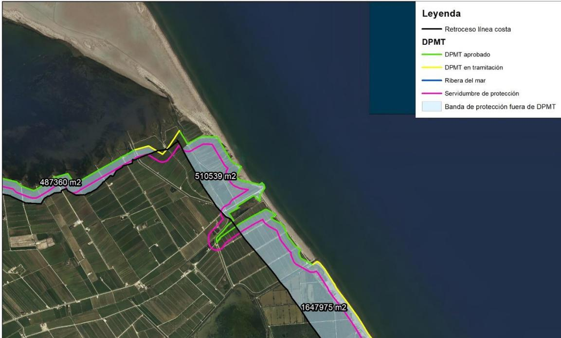
Figura 24. Banda de protección en el horizonte temporal de 2100; Zona 2 (Z<sub>2</sub>) (Foto: PNOA)
