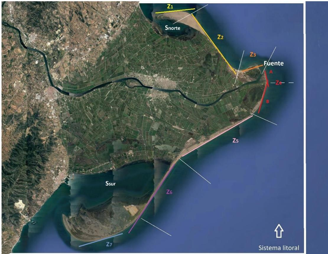
Figura 13. Sistema litoral y zonificación de la costa del Delta del Ebro (Foto: Google Earth)
