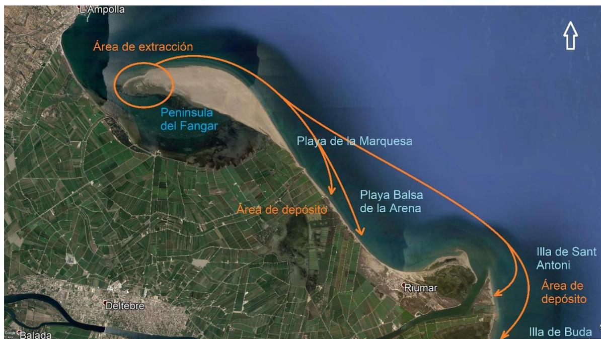
**Figura 30. Esquema del traslado propuesto desde la punta del Fangar hacia la desembocadura (Foto: Google Earth)**
