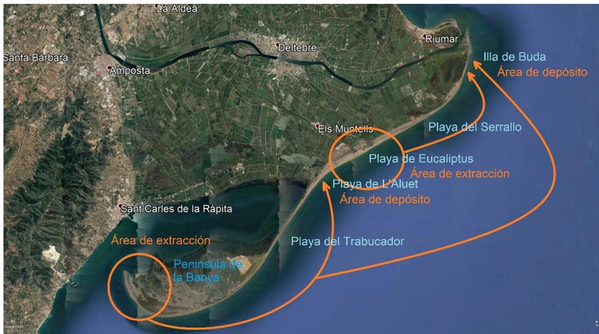
Figura 31. Esquema de los trasvases propuesto desde Eucaliptus hacia la Illa de Buda y desde la punta de la Banyà hacia el Trabucador (Foto: Google Earth)
